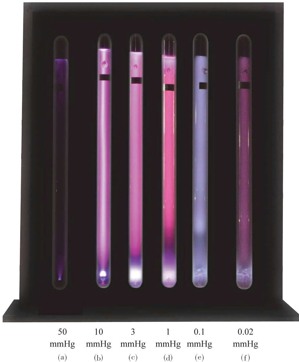
▲ 圖 10-3 當氣壓降至約 10 mmHg 時，高電壓氣體放電管內的空氣放出輝光；當氣壓繼續下降至約 0.02 mmHg 時，輝光已相當黯淡。
