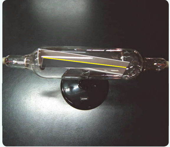
▲ 圖 10-6 自真空管左側射出的電子束（以灰色區域示意）打到斜放的螢光板可以顯示出陰極射線軌跡（以黃色實線示意）。
