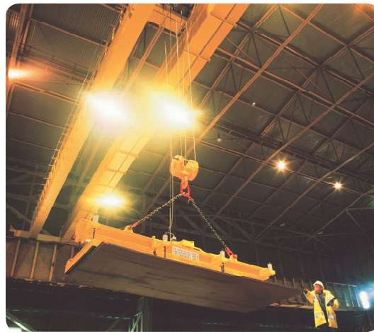
▲ 圖 8-26 工業用的電磁鐵起重機，可搬運鐵製物品，或用以區分磁性和非磁性物件。
