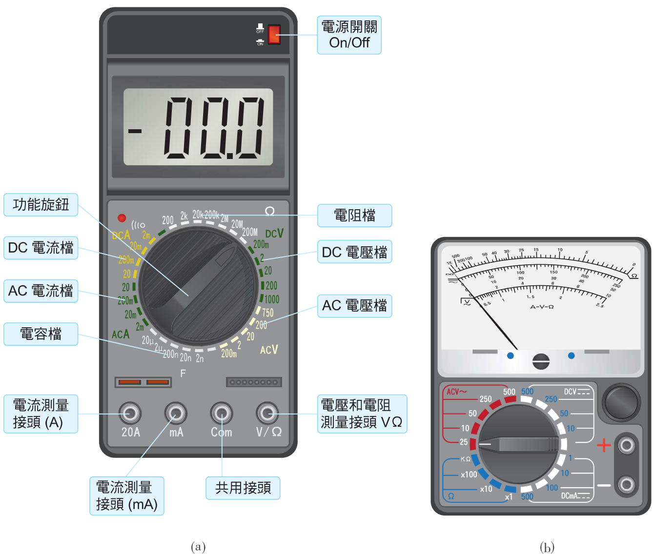
▲ 圖 7-17 (a)數位型的三用電表；(b)類比（指針）型的三用電表。
