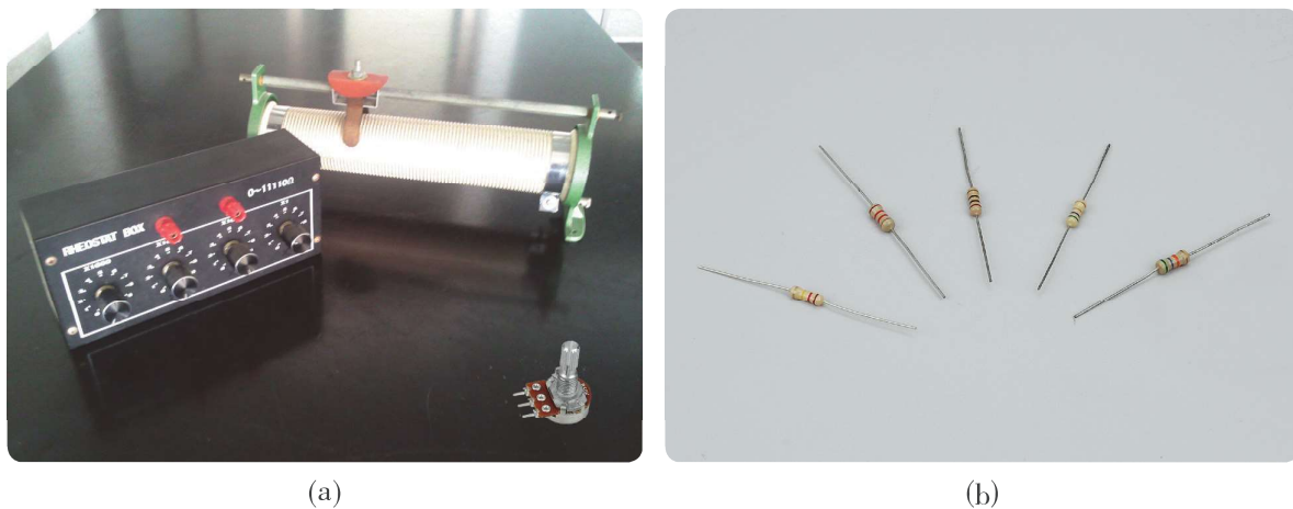
▲ 圖 7-8 (a)三種可變電阻與(b)柱狀電阻都符合歐姆定律。
