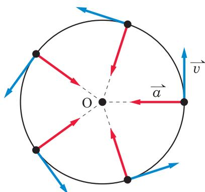
◀ 圖 5-5 質點以等速率作圓周運動，在不同位置時的速度  $\vec{v}$  和加速度  $\vec{a}$  相互垂直，且加速度方向恆指向圓心。
