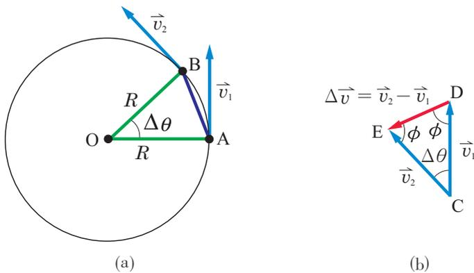
▲ 圖 5-3 (a) 質點以等速率  $v$  由 A 點移動至 B 點，對圓心轉過  $\Delta\theta$ ，速度由  $\vec{v}_1$  變化為  $\vec{v}_2$ ；
