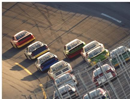
▲ 圖 5-8 在公路的轉彎處鋪設成傾斜的路面，以利汽車改變速度的方向。
