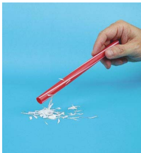
圖 6-2 帶電的塑膠吸管吸引紙片。
