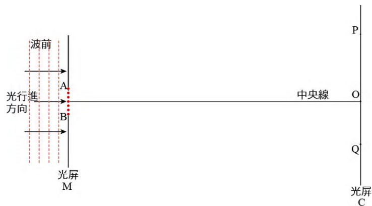
▲圖 5-20 單狹縫繞射實驗示意圖，遠處光屏 C 上每一點均受無限多光線照射。
