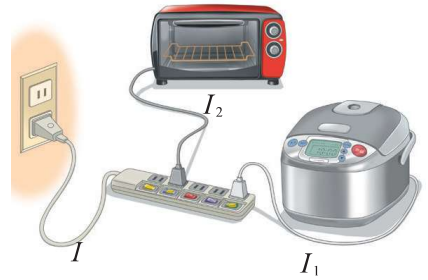
▲ 圖 7-25 多孔插座雖可供數個電器同時使用，但總電流 I 不能超過該插座所容許的最大安全電流。 I_1 與 I_2 分別為電器的電流， I = I_1 + I_2 。
