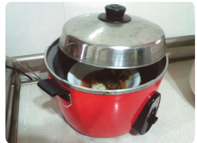
▲ 圖 7-24 當電流通過電鍋內的電阻時，由電能轉換的熱能可以加熱食物。
