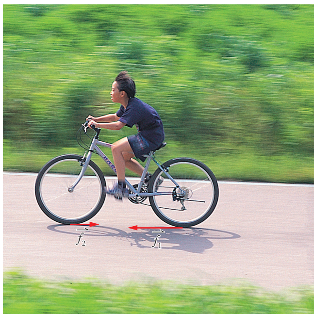
▲ 圖 4-44 騎腳踏車時，前輪與後輪皆受摩擦力作用。
