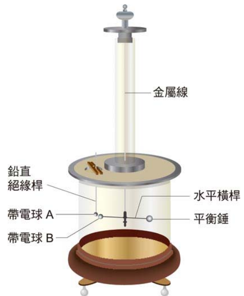
圖 6-9 庫侖進行扭秤實驗，證實兩點電荷間的靜電力與距離的平方成反比的關係。
